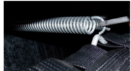
Ein- bzw. Aushängen von Federn mit Einspannhaken
